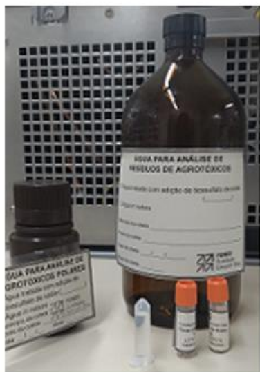
FIGURA 8: Kit completo de coleta de amostra de água para um mesmo ponto de coleta .
